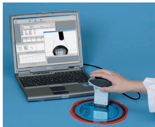
Abb. 3: Rechnergesteuertes Kontaktwinkelmessgerät „Mobile Drop“ [1]
